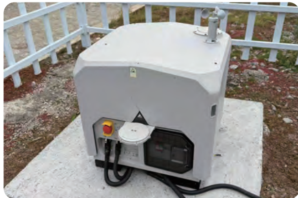
■ 新增无人机自主巡检设备
